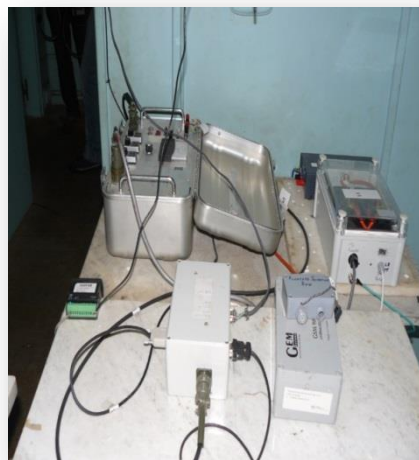
Fig 6. A la izq. se muestra el variómetro triaxial y el magnetómetro de precesión protónica en sus correspondientes ubicaciones. A la der. se observa la electrónica de estos equipos. Este instrumental se encuentra en la casilla “de variómetros”.
