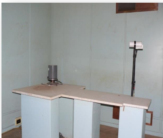
Fig 6. A la izq. se muestra el variómetro triaxial y el magnetómetro de precesión protónica en sus correspondientes ubicaciones. A la der. se observa la electrónica de estos equipos. Este instrumental se encuentra en la casilla “de variómetros”.
