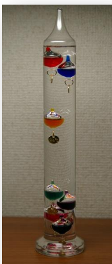
Termómetro de Galileo.
