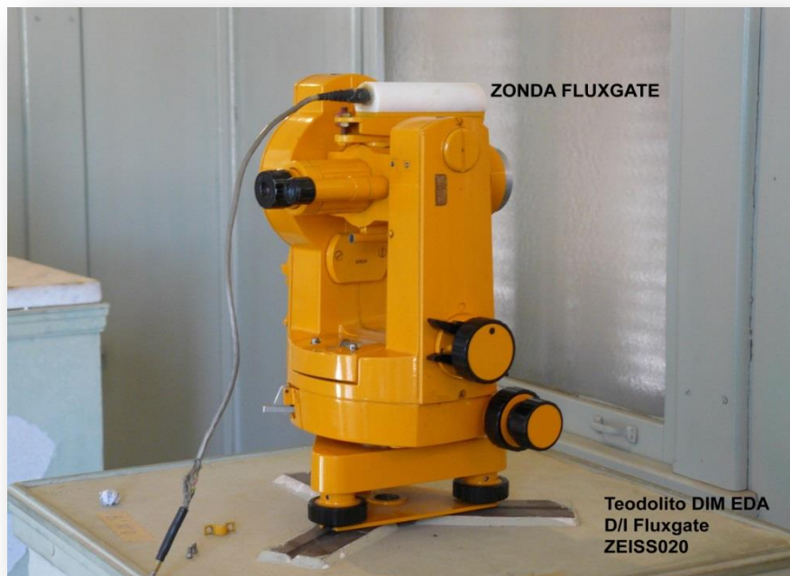
Fig 5. Teodolito D/I Fluxgate instalado en su correspondiente base y pilar. Se encuentra dentro de la casilla “de absolutas”.
