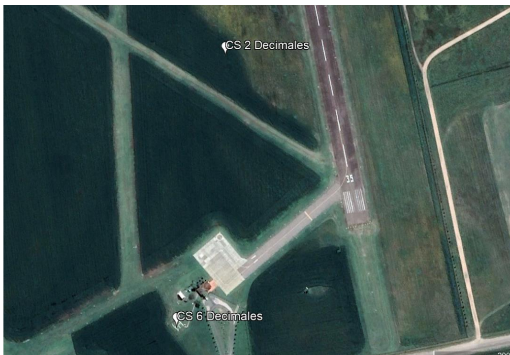
Figura 1: Posición de la estación automática de Coronel Suarez. Con una precisión de 6 decimales nos ubica en el campo de observación mientras que con 2 decimales nos encontramos a más de 200 mts.
