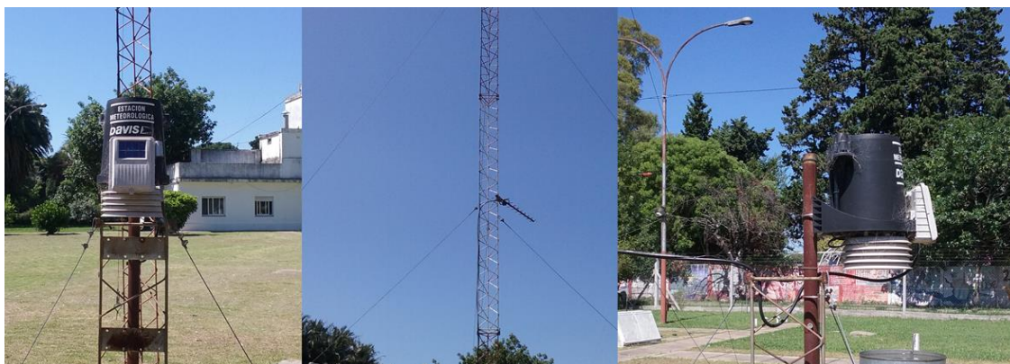
Figura 8: En esta figura tenemos un panorama de otros componentes de la estación, que pueden detallar el estado de los mismos; Panel, Pluviómetro, Antena, Soporte, etc.
