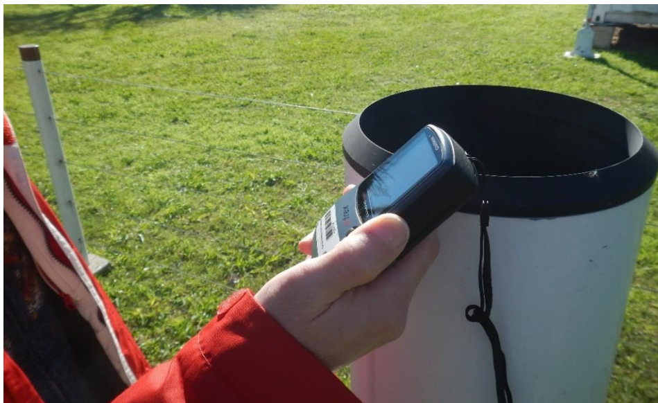
Figura 2: Adquisición de coordenadas geográficas sobre la boca del pluviómetro utilizando un GPS.
