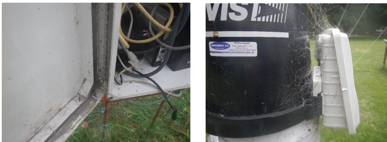
Figura 9: Tierra y plagas sobre diversas partes de la estación.
