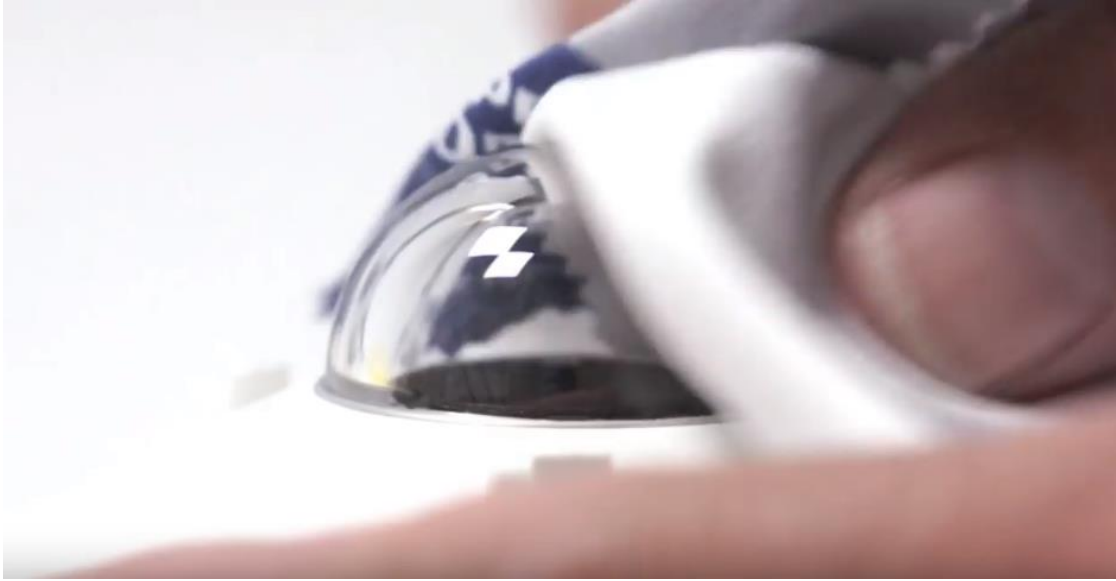
Figura 3: Limpieza con paño de la cúpula de un piranómetro.
