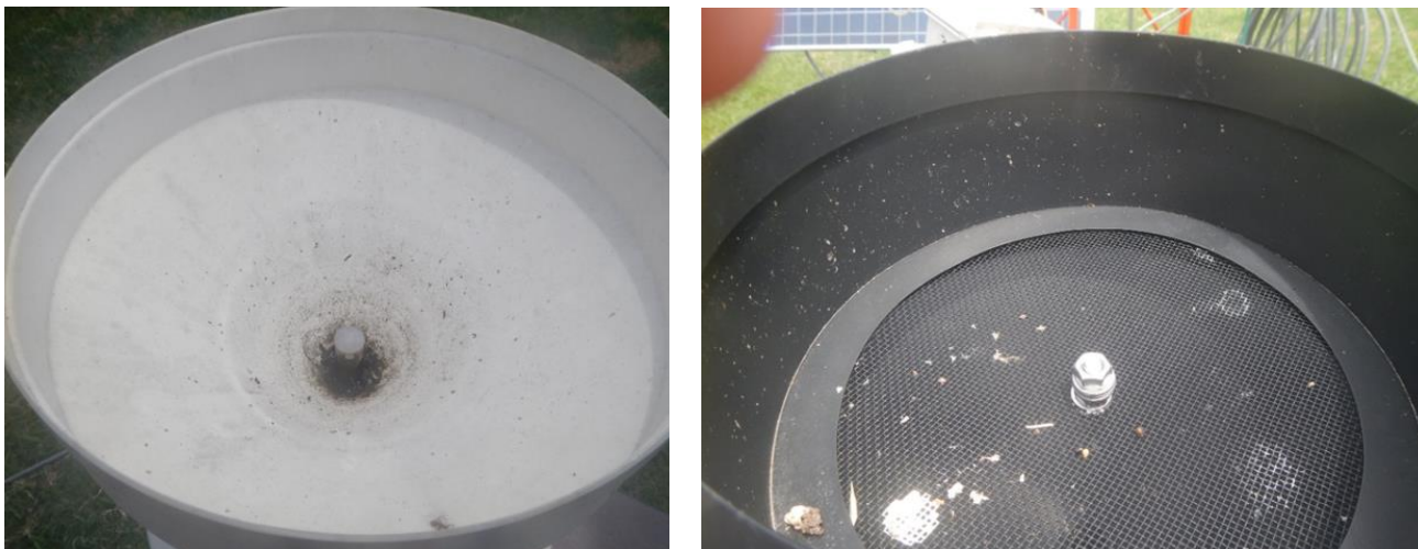
Figura 5: Embudo de sensor de precipitación, la suciedad bloquea el ingreso de agua afectando las mediciones.
