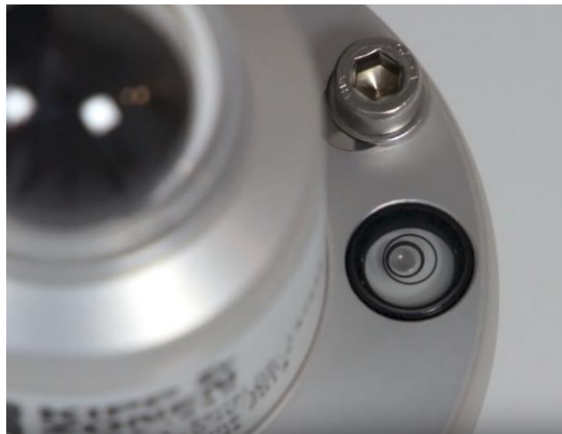
Figura 4: Burbuja de nivelación presente en muchos sensores.
