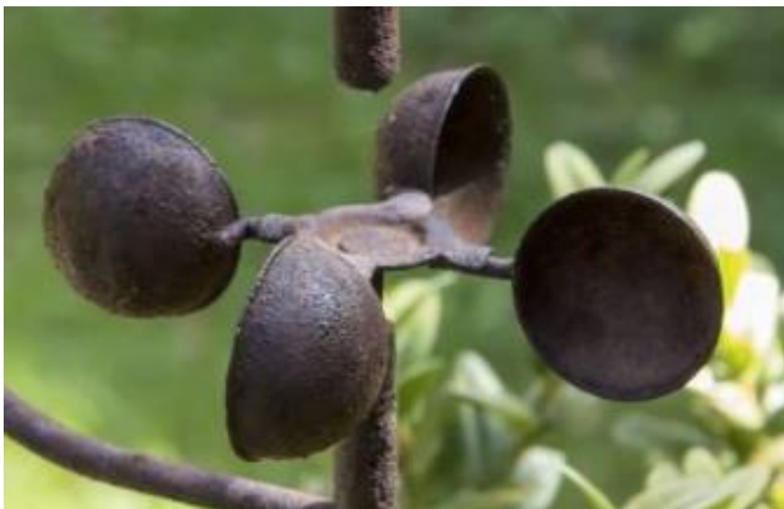
Figura 7: Anemómetro con oxidación. Debido a la presencia de óxido, salitre, hielo o polvo las partes mecánicas no giran libremente registrando datos erróneos.
