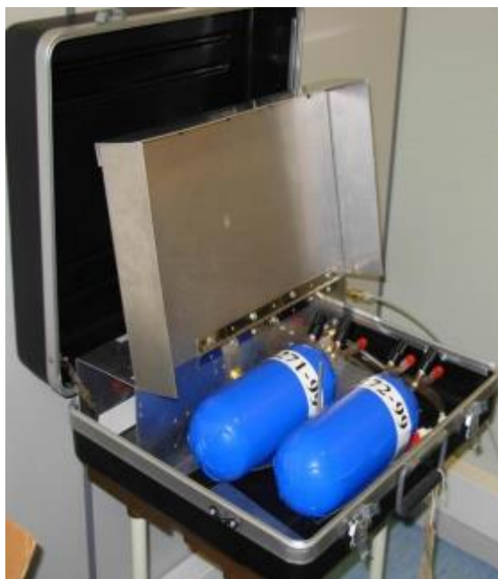
Figura A.1. Sistema de muestreo discontinuo de gases por medio de flask de NOAA.
