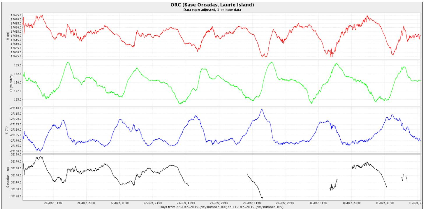
Figura 4c: Componentes del campo magnético del 16 al 31 de diciembre. En rojo se ve la componente horizontal (H) y en azul la vertical (Z), ambas en nT. En verde se presenta la declinación del campo magnético (D) en minutos y en negro la intensidad del campo magnético en nT.
