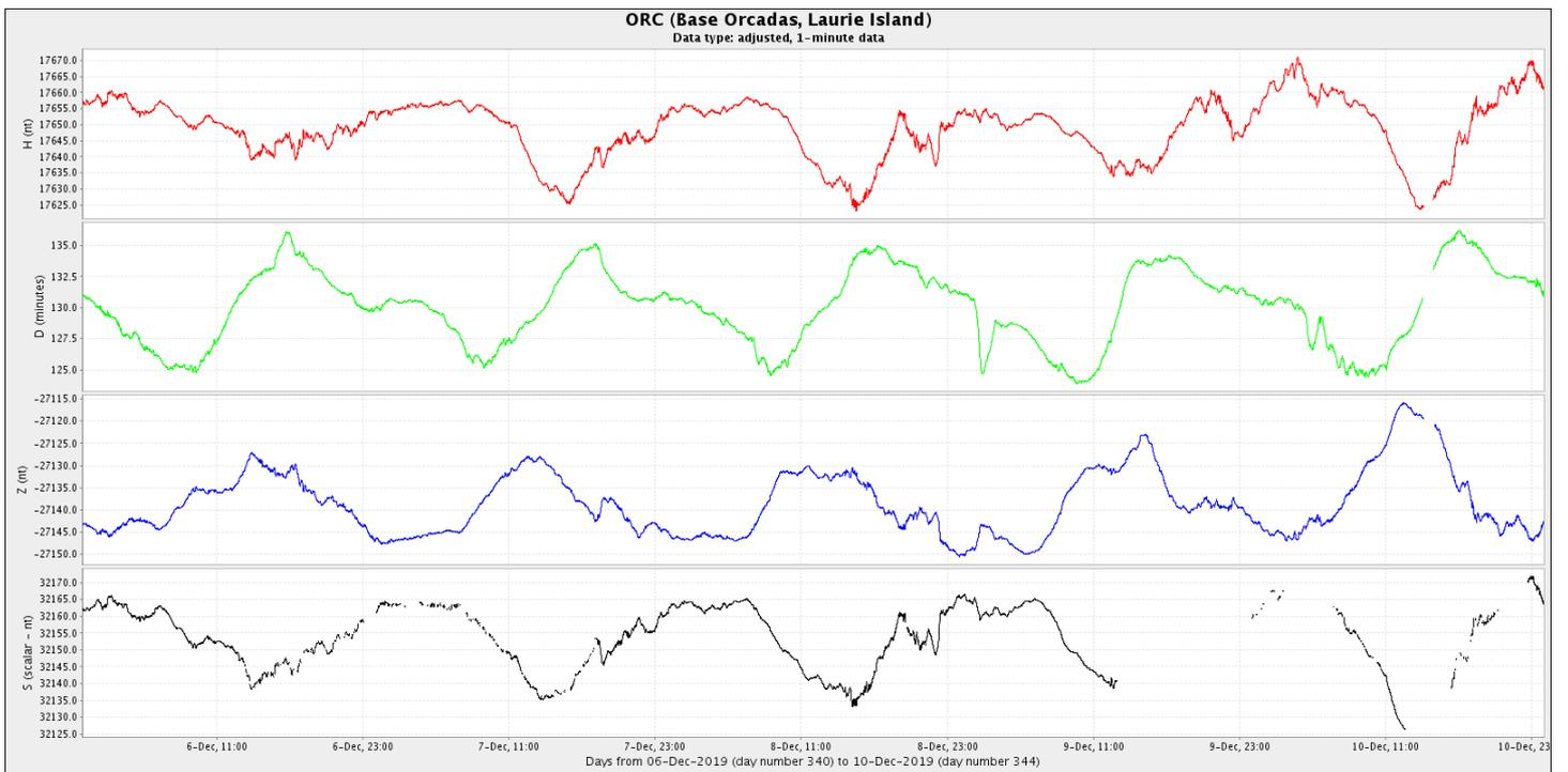
**Figura 4a:** Componentes del campo magnético del 1 al 10 de diciembre. En rojo se ve la componente horizontal (H) y en azul la vertical (Z), ambas en nT. En verde se presenta la declinación del campo magnético (D) en minutos y en negro la intensidad del campo magnético en nT
