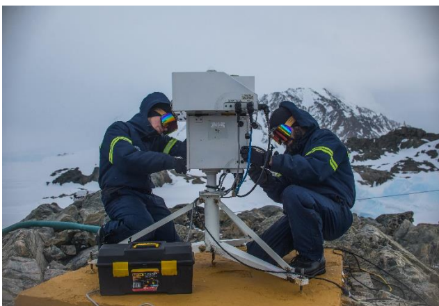
Técnicos del IAA Ezequiel Peschiera y Nahuel Solís Etchegoin realizando mantenimiento al Brewer de San Martín
