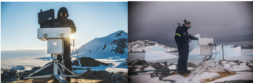
Test de lámpara y mantenimiento diario del espectrofotómetro Brewer de Base San Martín por el personal técnico del IAA Ezequiel Peschiera y Nahuel Solís Etchegoin.
