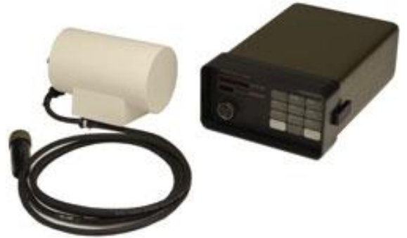
Figura 3: Magnetómetro de Precesión Protónica, Marca Geometrics, Modelo G856
