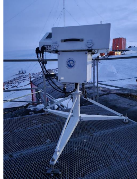
En la imagen se puede ver al Téc. Santiago Kyanka realizando el mantenimiento anual del Espectrofotometro Brewer en el laboratorio LABEL de base Belgrano II.
