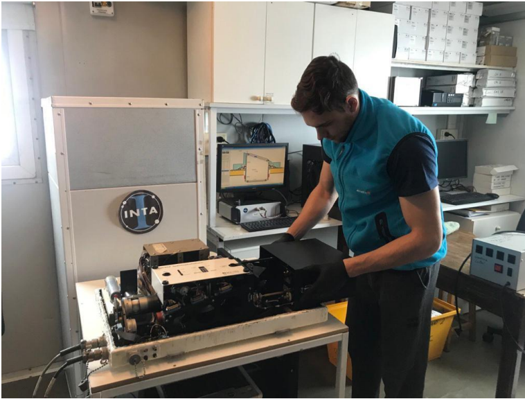
En la imagen se puede ver al Téc. Santiago Kyanka realizando el mantenimiento anual del Espectrofotometro Brewer en el laboratorio LABEL de base Belgrano II.
