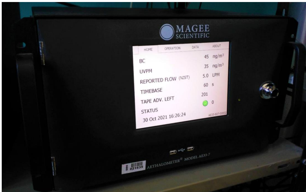
Figura 1: Foto del aethalometer AE33 instalado en la estación de Vigilancia Atmosférica Global (VAG) en Ushuaia.
