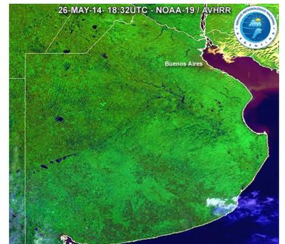
Imagen composición color entre bandas (RGB 1-2-4). En la misma se puede observar en color azul brillante los ríos, lagunas y áreas anegadas. Los tonos de azul menos intensos, corresponden a distintos niveles de humedad del suelo.
