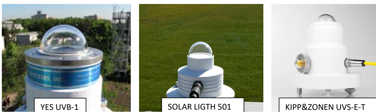
Figura 3. Radiómetros utilizados para medir radiación solar UV en las estaciones del SMN.
