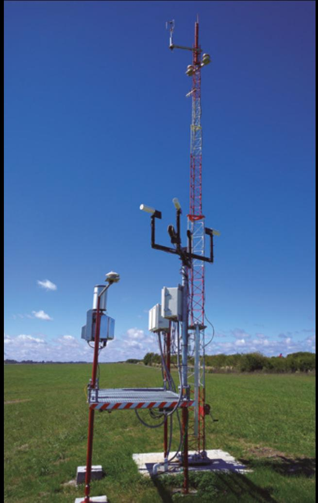
Sistema Automático de Observación Meteorológica (AWOS) para aeropuertos, aeródromos y helipuertos.
