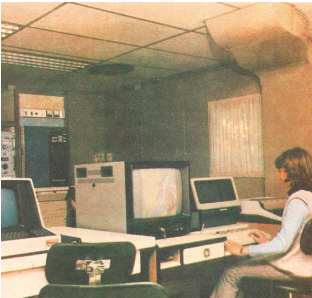
Vista interior de la estación HRPT-AR en OCBA. En primer plano se observan dos terminales alfanuméricas y parte del procesador de imágenes, al fondo la unidad de grabación, los receptores y parte del sistema de cómputos. CABA, c. 1987. Fuente: SMN.
