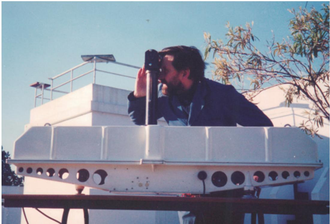
Operador de espectrofotómetro Dobson midiendo la columna de ozono total en OCBA. CABA, 1980.
