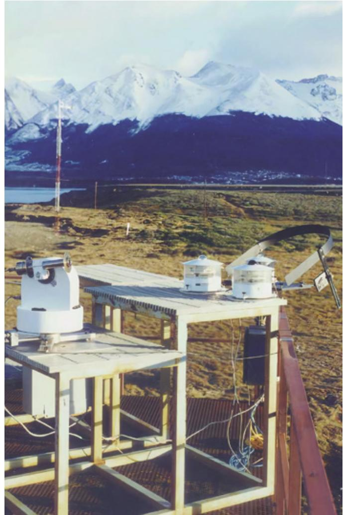
Instrumentos de medición de radiación solar directa, global, difusa e IR (infrarrojo) en Estación de Vigilancia Atmosférica Global (VAG). Ushuaia, Tierra del Fuego, Antártida e Islas del Atlántico Sur, c. 1995.
