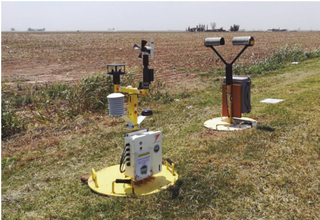
Estación meteorológica automática y disdrómetro (proyecto RELAMPAGO-CACTI). Río Tercero, Córdoba, 2018.
