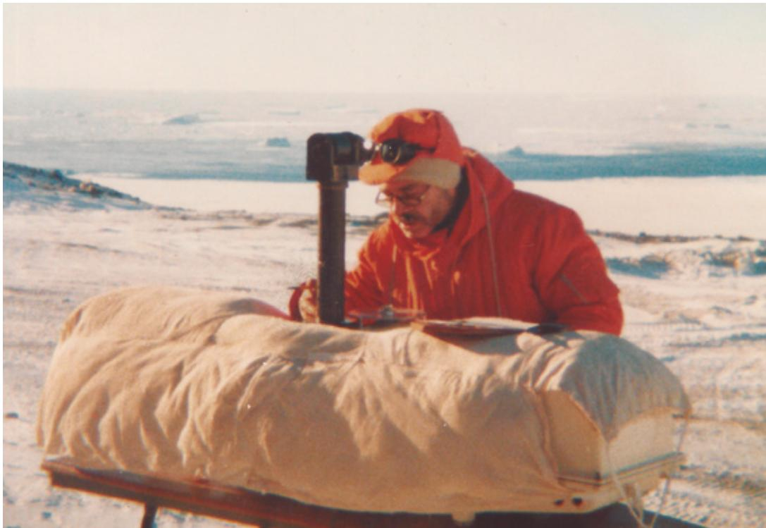
Primer año de mediciones de ozono con espectrofotómetro Dobson en estación Marambio. Antártida Argentina, 1987.
