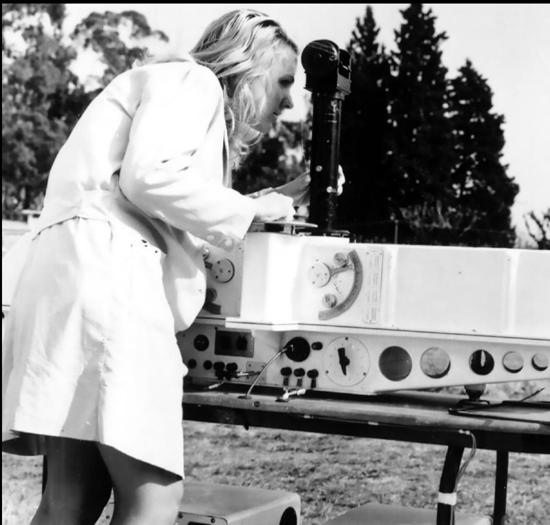
Operadora de espectrofotómetro Dobson midiendo la columna de ozono total en OCBA. CABA, c. 1972.
