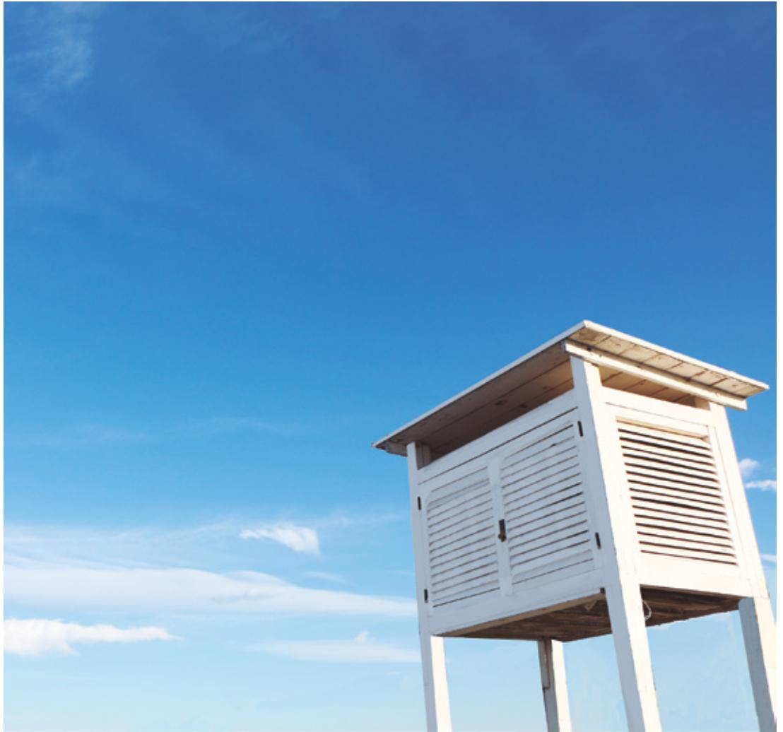
Abrigo meteorológico. Contiene instrumentos que miden la temperatura y estiman la humedad del aire.
