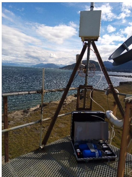
Figura 3. Sistema de muestreo portátil con el cual se llevó a cabo un monitoreo in situ el programas de COV en la estación VAG Ushuaia.
