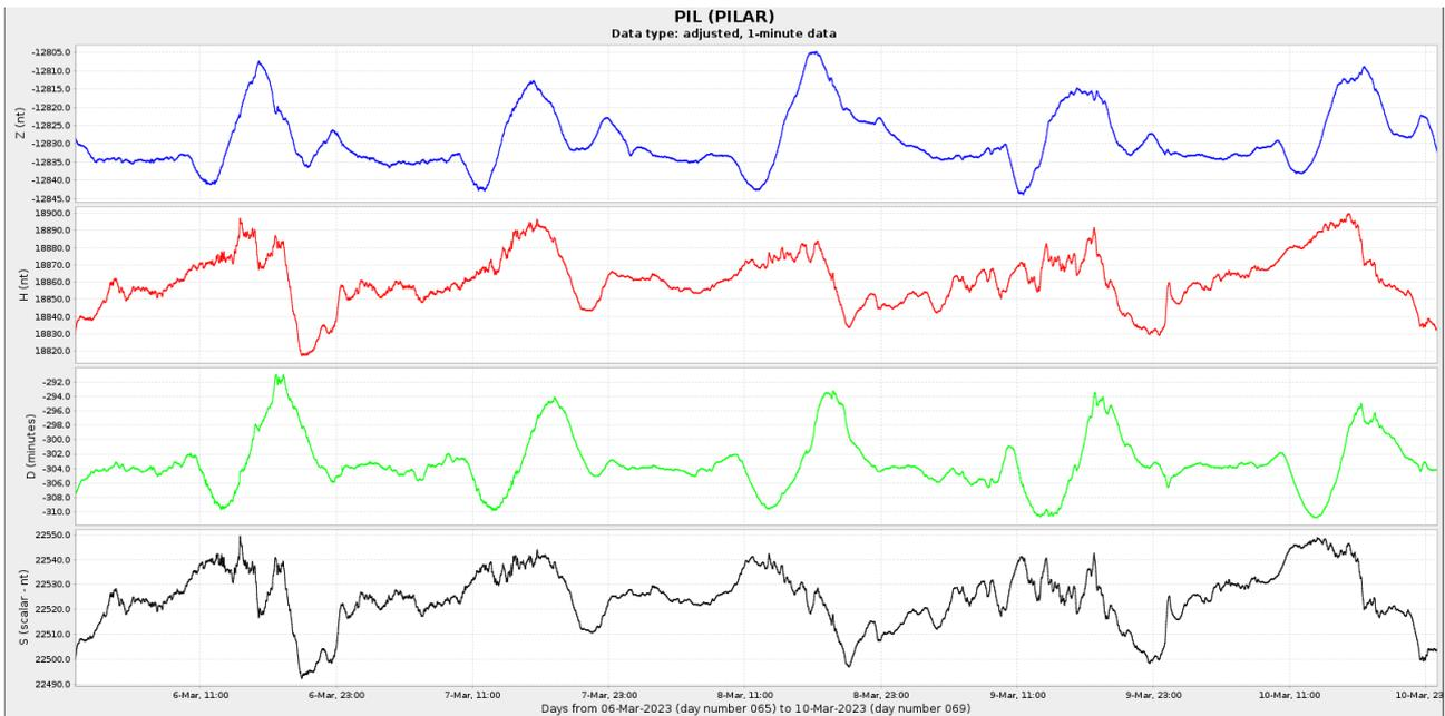
**Figura 4a:** Componentes del campo magnético del día 1 al 10 de marzo. En rojo se ve la componente horizontal (H) y en azul la vertical (Z), ambas en nT. En verde se presenta la declinación del campo magnético (D) en minutos y en negro la intensidad del campo magnético en nT.
