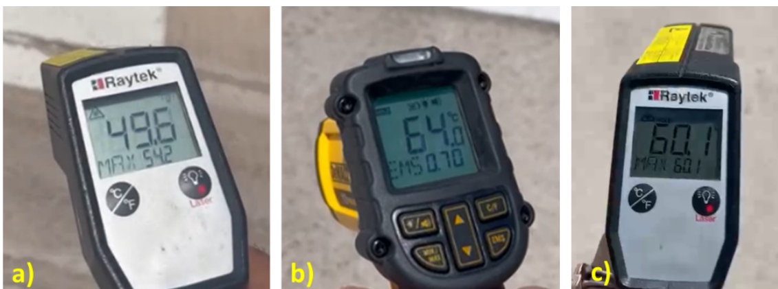
Fig. 4 Valores de temperatura medidos en AD SDE. a) 08/12/2022 – 11:15 HOA (14:15 UTC) con pistola ‘Raytek’; b) 29/01/2023 – 14:30 HOA (17:30 UTC) con pistola ‘DeWalt’; c) 13/02/2023 – 15:42 HOA (18:42 UTC) con pistola ‘Raytek’.
