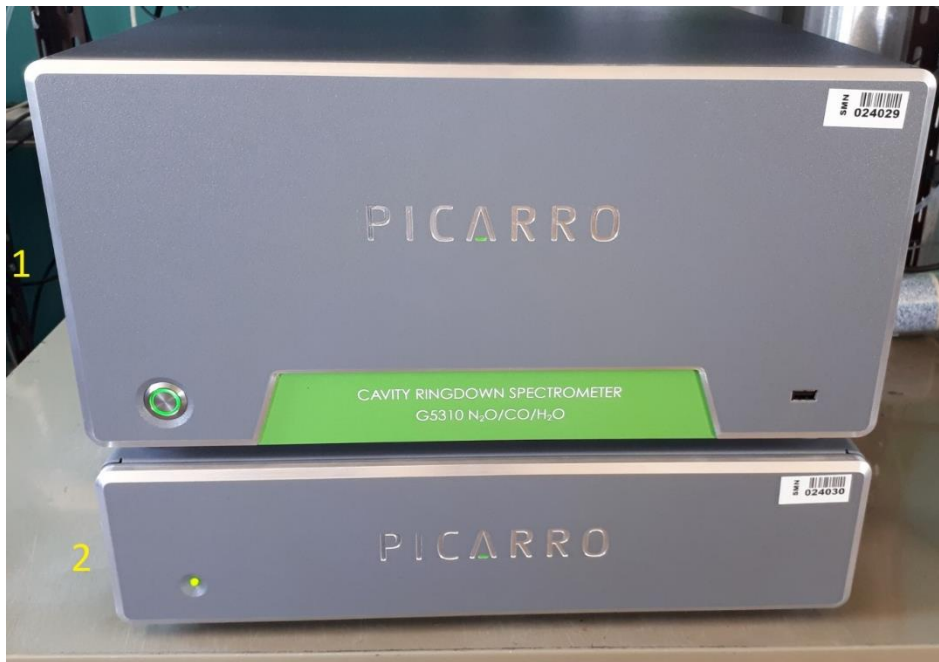
Fig. 3: Parte frontal del Picarro G5310 instalado en la VAG Ushuaia, se observan (1) el analizador y (2) la bomba.
