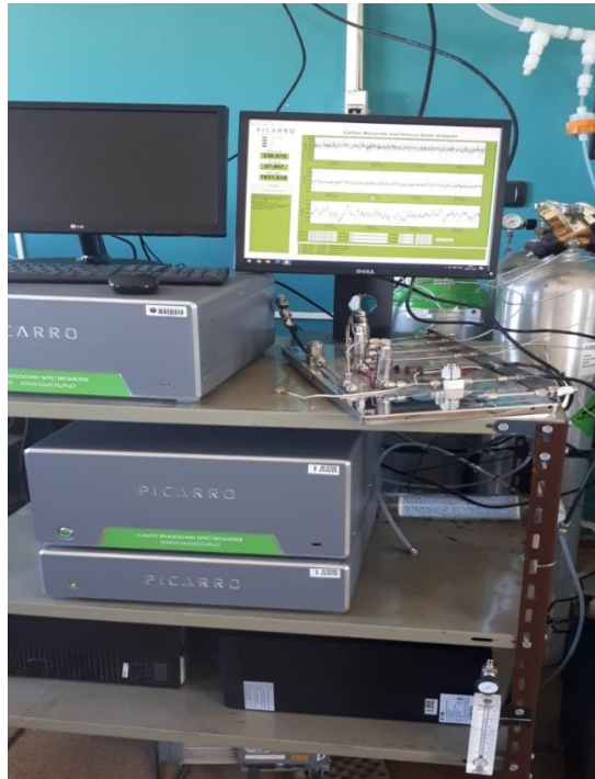
Fig. 7: Disposición final del Picarro G5310 dentro de la sala principal de la VAG Ushuaia junto al analizador Picarro G2401 (para mediciones de CO 2 y CH 4 ).
