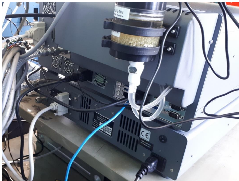
Fig. 4: Parte trasera del Picarro G5310 instalado en la VAG Ushuaia, se observan conexiones y el refrigerante.
