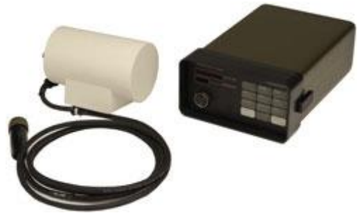
Figura 3: Magnetómetro de Precisión Protónica, Marca Geometrics, Modelo G856
