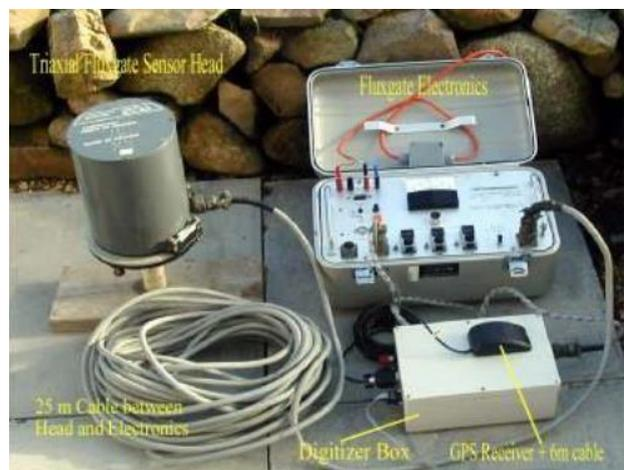
cambios en los campos magnéticos generan una corriente eléctrica en la segunda bobina, conocida como la “bobina de detección”, que a continuación se puede medir.
