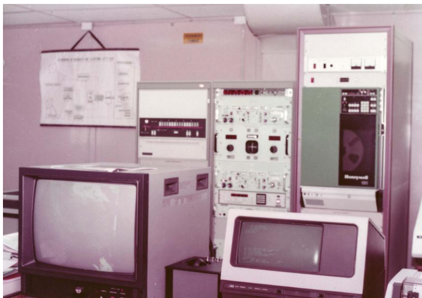
Año 1983. Vista interior de la Estación HRPT. Villa Ortúzar. En primer plano se observa una terminal alfanumérica y parte del procesador de imágenes; al fondo la unidad de grabación, los receptores y parte del sistema de cómputo.
