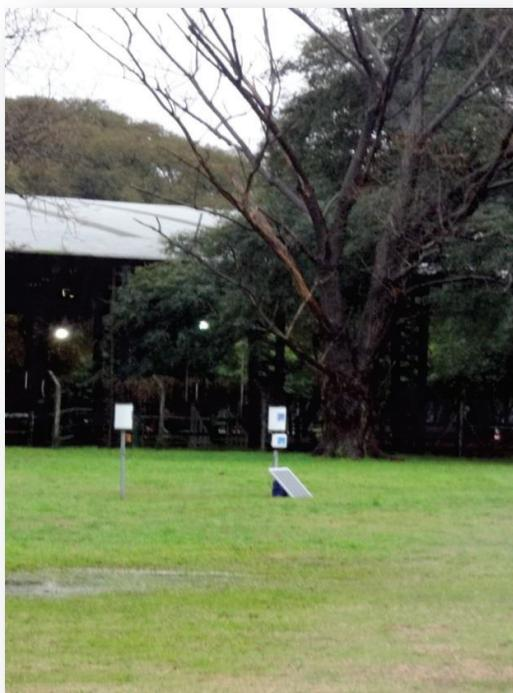
El rango de medición es 0 a 200 mm/h, la precisión de 0.2 mm.
