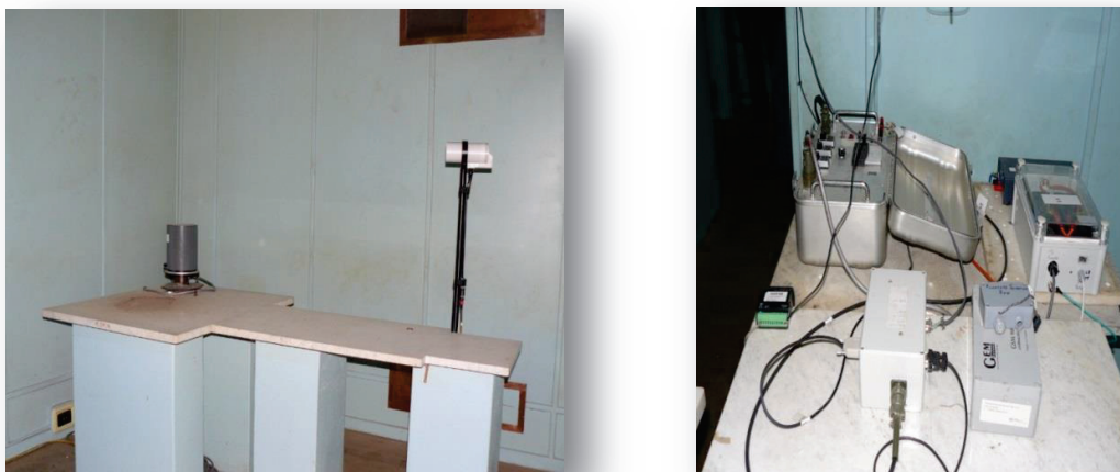
Fig 6. A la izq. se muestra el variómetro triaxial y el magnetómetro de precesión protónica en sus correspondientes ubicaciones. A la der. se observa la electrónica de estos equipos. Este instrumental se encuentra en la casilla “de variómetros”.
