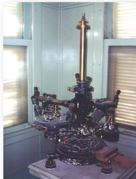
Fig 2. Teodolito magnético Schmidt con el cual se medía la declinación magnética. Pilar, Córdoba.
