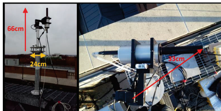
FIGURA 6: SISTEMA PANDORA MONTADO SOBRE UNA PLATAFORMA
