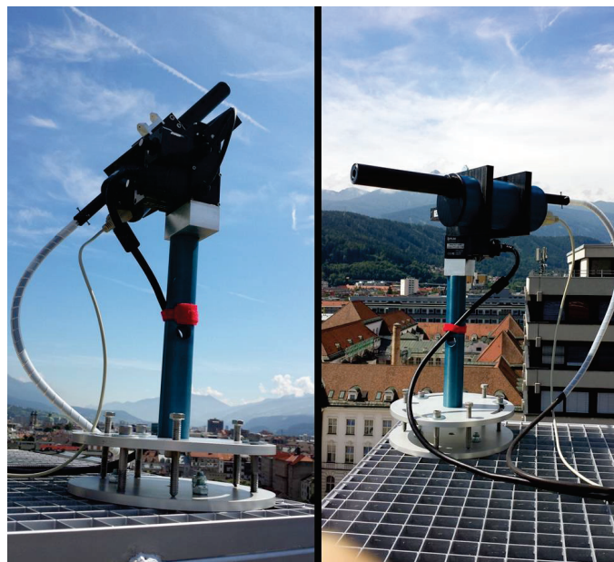
FIGURA 23: LA FIBRA TIENE QUE TENER LIBRE MOVIMIENTO
