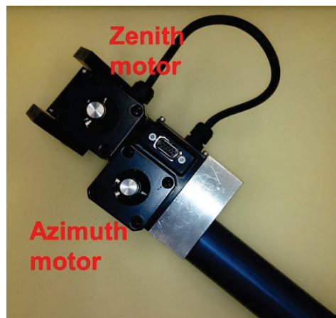
FIGURA 3: TRACKEADOR: SE OBSERVAN SUS DOS MOTORES
