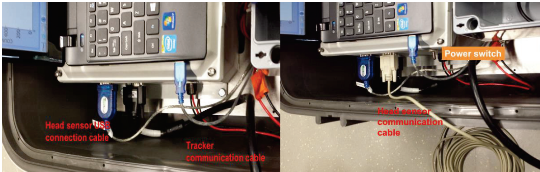
FIGURA 11: CABLES USB Y CABLE COMUNICACIÓN CON TRACKEADOR FIGURA 12: CABLES DE COMUNICACIÓN DEL CABEZAL
