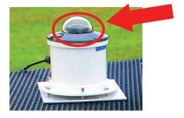
Limpiar el vidrio de la cámara con un trapo de microfibra y si es necesario con alcohol isopropilico.
