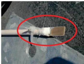
ILUSTRACIÓN 1: SENSOR DE HUMEDAD
