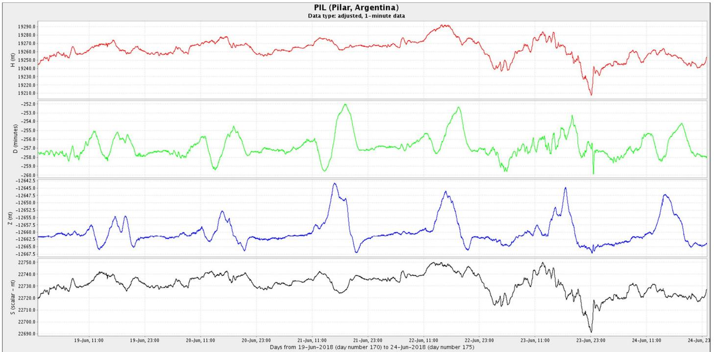
**Figura 4b:** Componentes del campo magnético del 13 al 24 de junio. En rojo se ve la componente horizontal (H) y en azul la vertical (Z), ambas en nT. En verde se presenta la declinación del campo magnético (D) en minutos y en negro la intensidad del campo magnético en nT.
