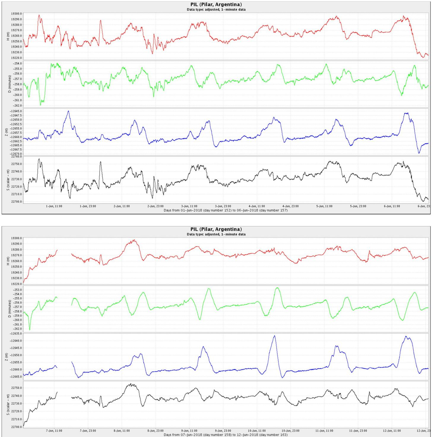
**Figura 4a:** Componentes del campo magnético del 1 al 12 de junio. En rojo se ve la componente horizontal (H) y en azul la vertical (Z), ambas en nT. En verde se presenta la declinación del campo magnético (D) en minutos y en negro la intensidad del campo magnético en nT
