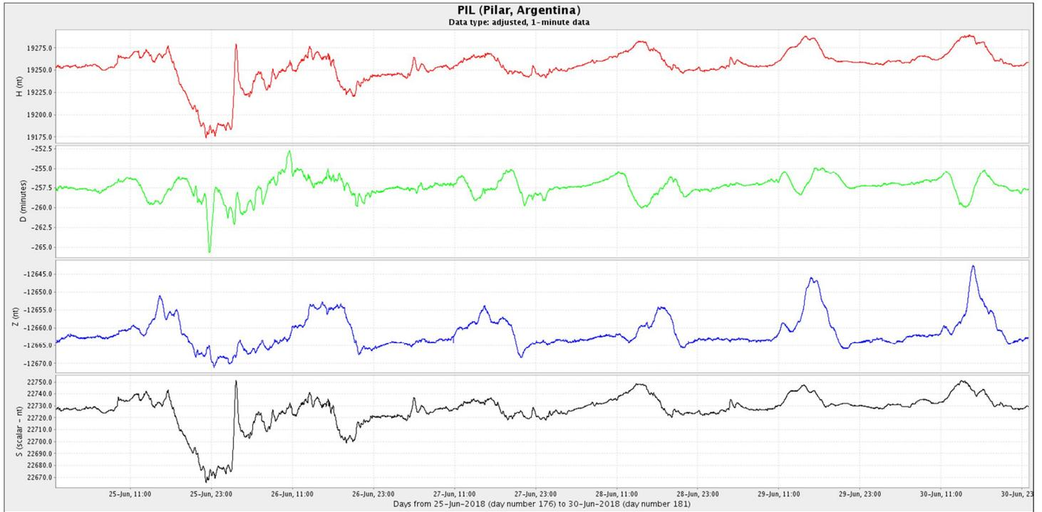
**Figura 4c:** Componentes del campo magnético del 25 al 30 de junio. En rojo se ve la componente horizontal (H) y en azul la vertical (Z), ambas en nT. En verde se presenta la declinación del campo magnético (D) en minutos y en negro la intensidad del campo magnético en nT.
