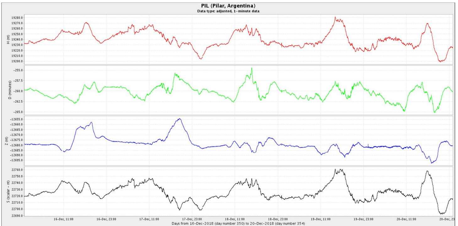
**Figura 4b:** Componentes del campo magnético del 13 al 20 de diciembre. En rojo se ve la componente horizontal (H) y en azul la vertical (Z), ambas en nT. En verde se presenta la declinación del campo magnético (D) en minutos y en negro la intensidad del campo magnético en nT.
