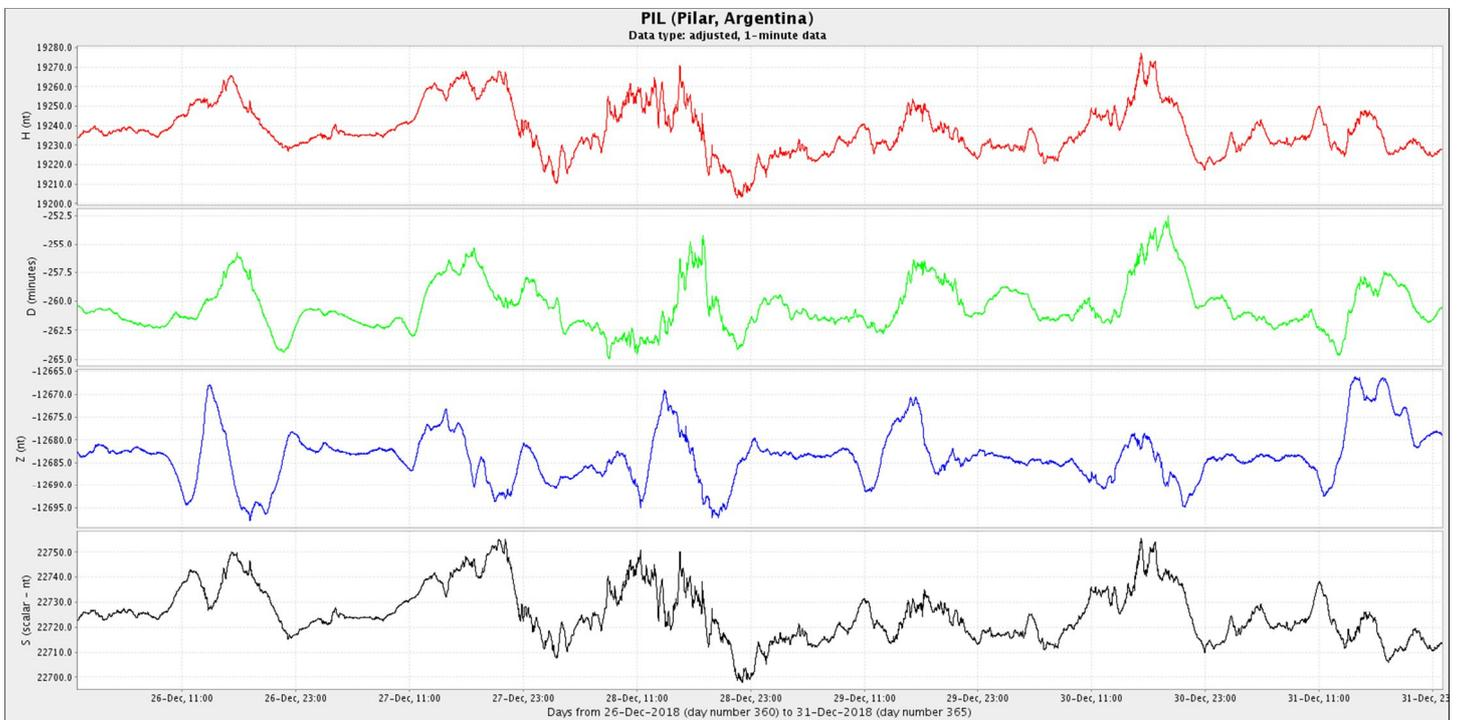
**Figura 4c:** Componentes del campo magnético del 21 al 31 de diciembre. En rojo se ve la componente horizontal (H) y en azul la vertical (Z), ambas en nT. En verde se presenta la declinación del campo magnético (D) en minutos y en negro la intensidad del campo magnético en nT.
