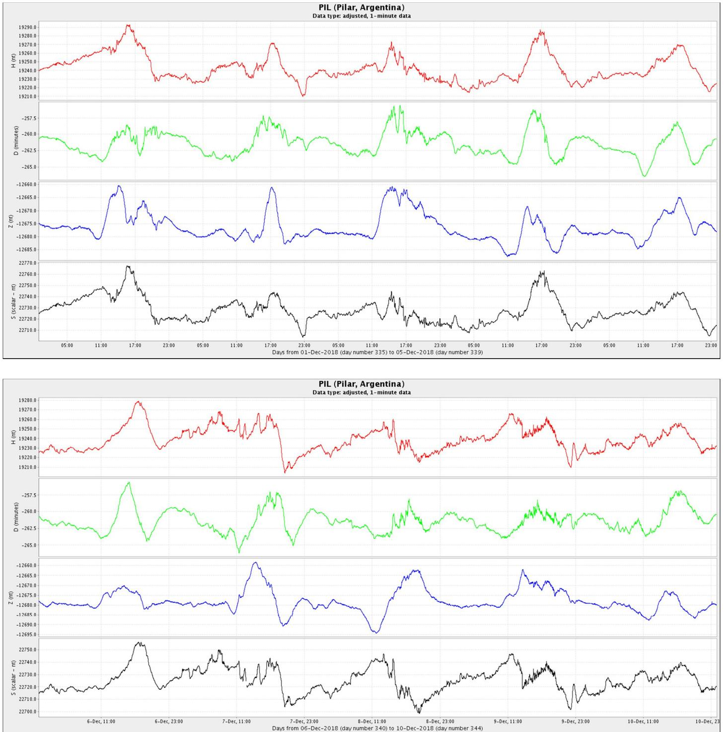
**Figura 4a:** Componentes del campo magnético del 1 al 10 de diciembre. En rojo se ve la componente horizontal (H) y en azul la vertical (Z), ambas en nT. En verde se presenta la declinación del campo magnético (D) en minutos y en negro la intensidad del campo magnético en nT
